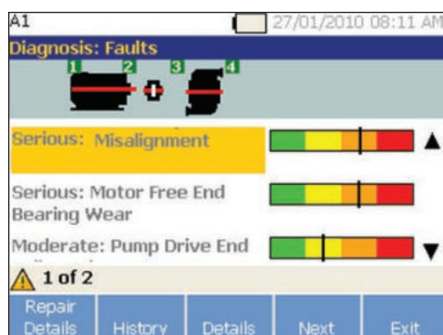
2. Indicazioni per diagnosi e riparazioni con lo strumento per vibrazioni Fluke.
