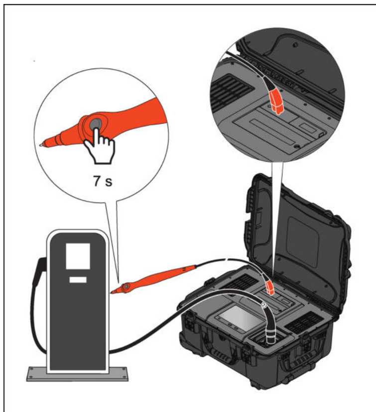
Figura 5. Esecuzione del test di continuità
