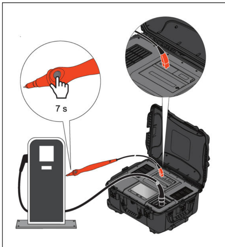
Figura 5. Esecuzione del test di continuità
