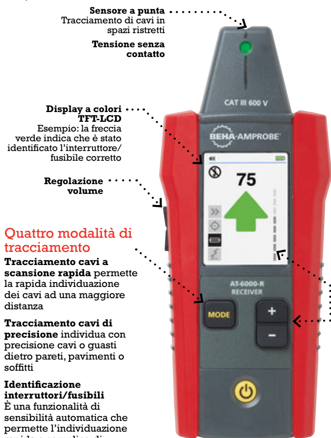
AT-6000-RE Ricevitore CAT III 600 V
