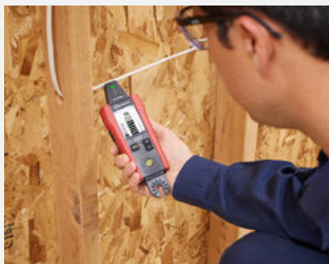
Localizzazione cavi alimentati e non alimentati
