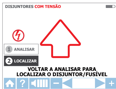
Figura 3.3d: Modo LOCALIZAR - Procurar o disjuntor/fusível correto
