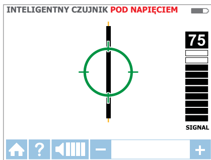
Rysunek 3.1f: Odbiornik zablokowany na przewodzie
