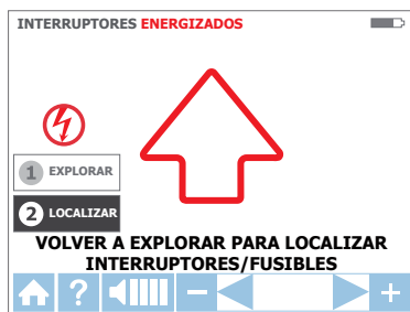
Figura 3.3d: Modo LOCATE (UBICACIÓN): búsqueda del disyuntor/fusible correcto
