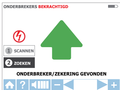
Afbeelding 3.3f: Modus ZOEKEN - stroomonderbreker/zekering geïdentificeerd
