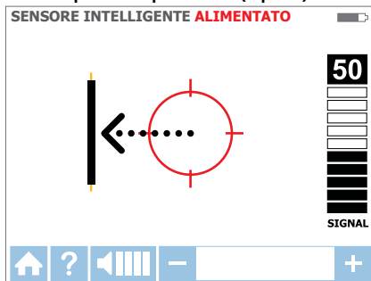
Figura 3.1e: Cavo a sinistra
