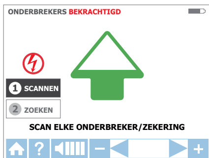
Afbeelding 3.3c: SCAN-modus – Stroomonderbrekers/zekeringen scannen
