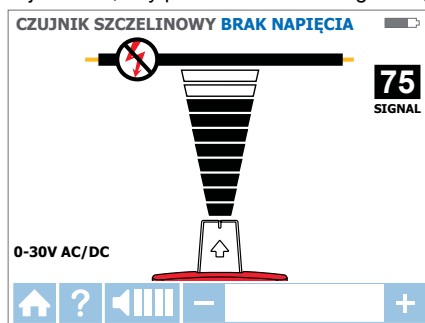
Rysunek 3.2c: Odbiornik pokazuje sygnał wykryty w trybie CZUJNIK Z KOŃCÓWKĄ bez napięcia
