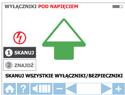
Rysunek 3.3c: Tryb WYSZUKAJ – Wyszukiwanie wyłączników/bezpieczników
