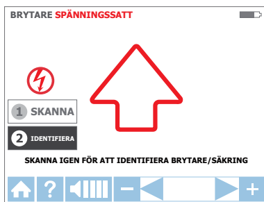
Figur 3.3d: LOKALISERA-läge - Söker efter rätt brytare/säkring
