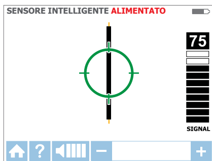
Figura 3.1f: Ricevitore bloccato sul cavo
