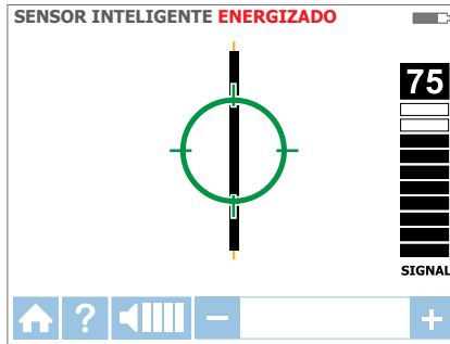
Figura 3.1f: Receptor bloqueado en cable
