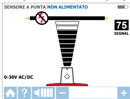
Figura 3.2c: Ricevitore che mostra il segnale rilevato in modalità SENSORE PUNTA senza tensione
