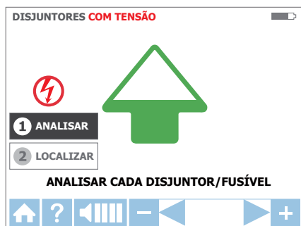
Figura 3.3c: Modo PROCURAR - Procurar disjuntores/fusíveis
