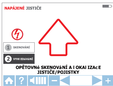
Obrázek 3.3d: Režim HLEDÁNÍ – Hledání správného jističe/pojistky
