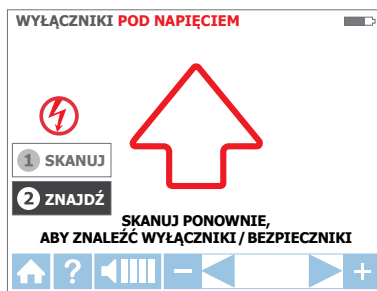
Rysunek 3.3d: Tryb LOKALIZUJ – Wyszukiwanie prawidłowych wyłączników/bezpieczników
