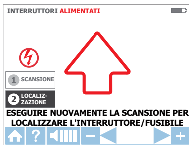
Figura 3.3d: Modalità LOCATE (Trova) – Ricerca di salvavita/fusibili corretti
