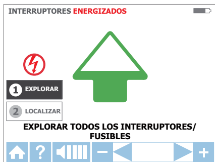
Figura 3.3c: Modo de SCAN (LECTURA): lectura de disyuntores/fusibles
