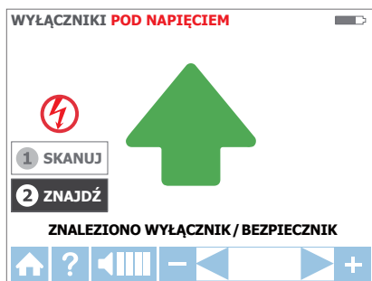
Rysunek 3.3f: Tryb LOKALIZUJ – zidentyfikowany wyłącznik/bezpiecznik
