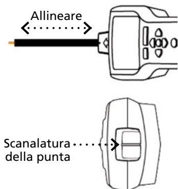
Figura 3.1h: Allineare il sensore punta con il cavo
