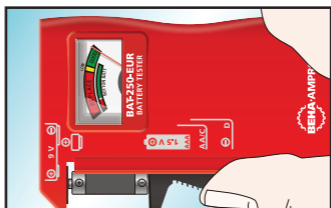
Comprobación de baterías de 1,5 V (AAA, AA, C, D)
