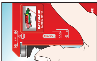
Comprobación de baterías de 1,5 V tipo botón
