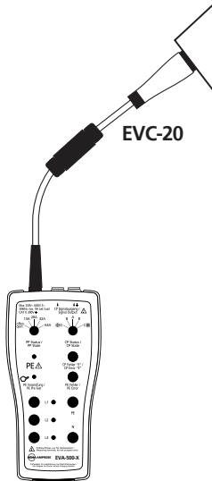
Kuva 6: Testisovittimen liitäntä latausasema tyyppi 2:een, jossa paneelikiinnityspistorasia
