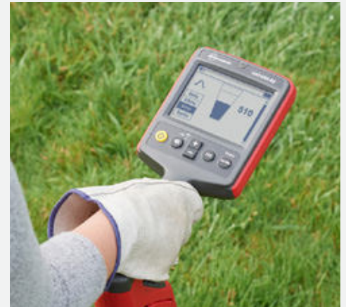
Lo schermo a LED ad alto contrasto del ricevitore è chiaramente visibile anche in piena luce solare
