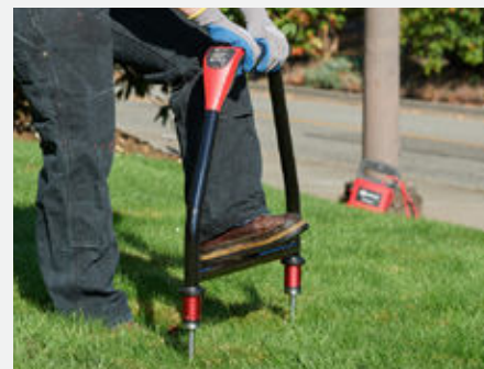
Individua la posizione di guasto utilizzando l'AF-600-EUR con il trasmettitore UAT-600-TE
