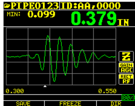
Segnale RF con cursore capovolto a "V" che indica dove viene effettuata la misurazione
