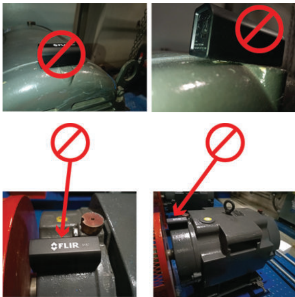
Figura 6.3 Esempi di aree in cui non posizionare i sensori.
