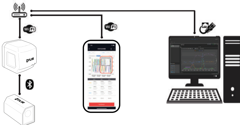
Figura 8.2 Diagramma a blocchi di un sistema controllato da un PC Windows. Il gateway GW65 comunica con il sensore SV87 tramite Bluetooth e con lo smartphone tramite un router Wi-Fi. Il PC comunica con la rete utilizzando una connessione Ethernet diretta.
