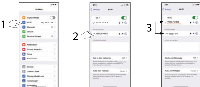
Figura 12.3 Esempio di configurazione di un dispositivo smart. Passaggio 1: toccare l'impostazione Wi-Fi sul dispositivo smart. Passaggio 2: toccare VS80 nell'elenco delle reti disponibili. Passaggio 3: notare che il VS80 è ora la rete connessa e che la rete personale (in questo esempio, My Network) si trova ora nell'elenco delle reti disponibili, ma non è più connessa. Per tornare alla rete, è sufficiente toccare il nome corrispondente nell'elenco delle reti disponibili (il VS80 verrà disconnesso).
