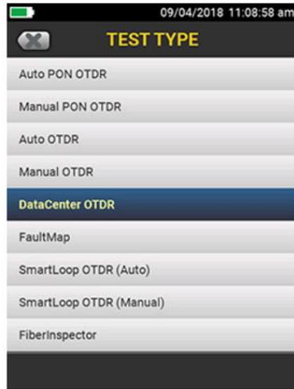
DataCenter OTDR Mode
