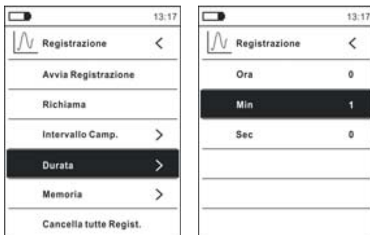
Fig. 36: Funzione data logger – Impostazione durata registrazione
