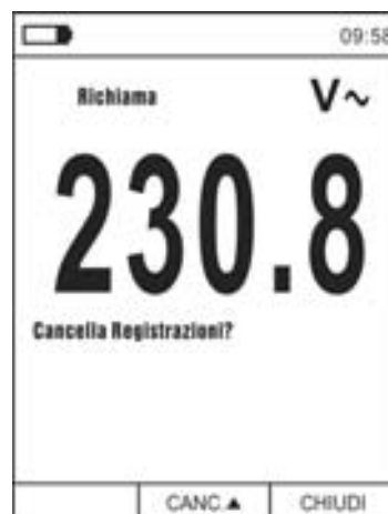
Fig. 40: Funzione data logger – Cancellazione registrazione
