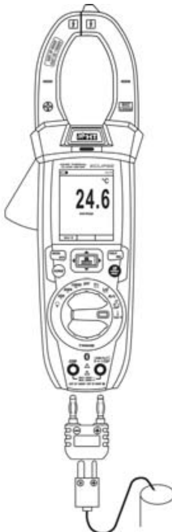
Fig. 30: Uso dello strumento per misura di Temperatura
