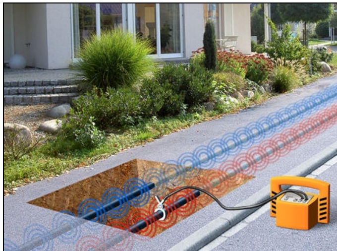
Fig. 6: Accoppiamento tramite pinza a induzione
