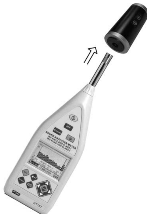
Fig. 36: Inserimento del calibratore HT151 sullo strumento
