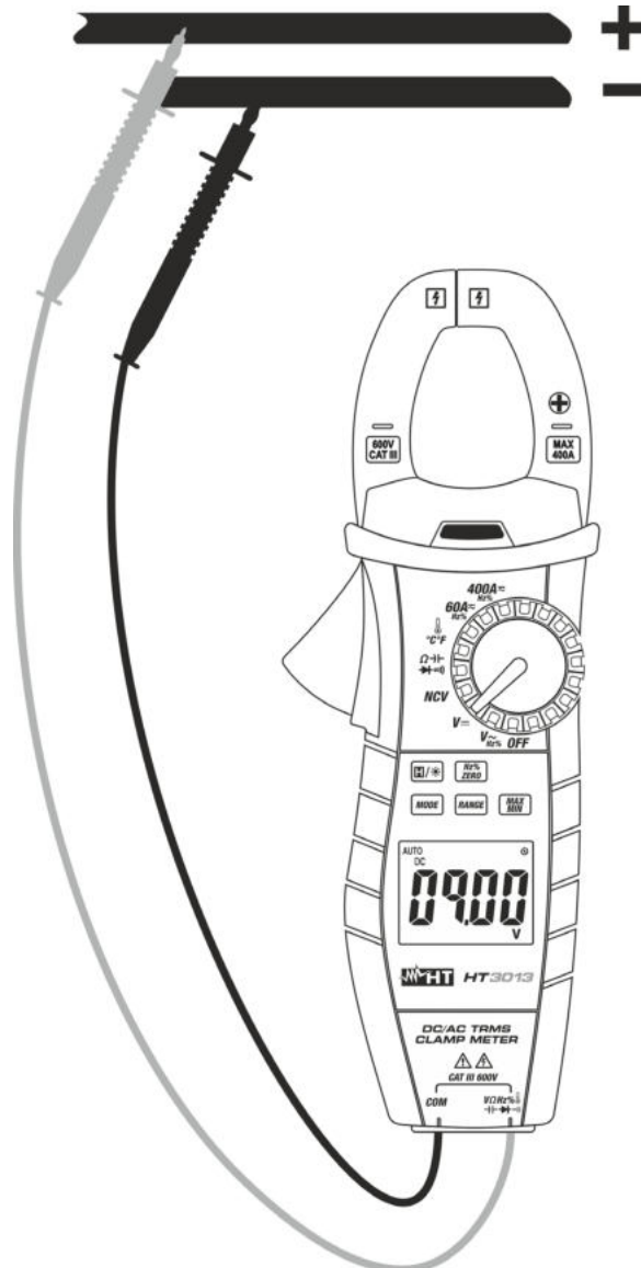
Fig. 3 : Utilisation de l'instrument pour mesure de Tension DC
