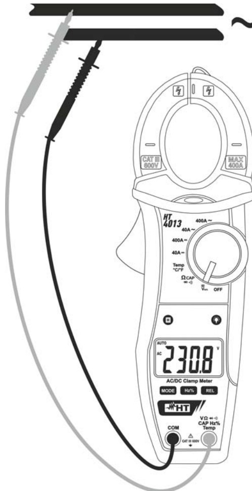
Fig. 4: Uso della pinza in misura di Tensione AC
