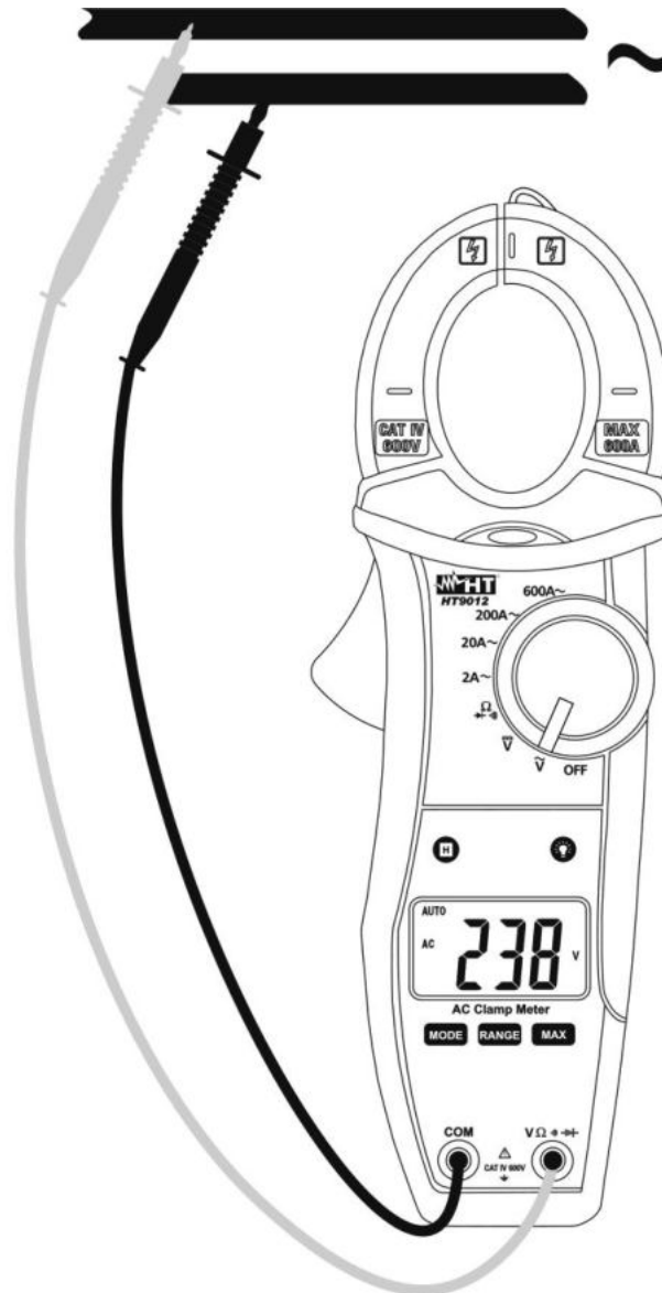
Fig. 4: Uso della pinza per misura di Tensione AC
