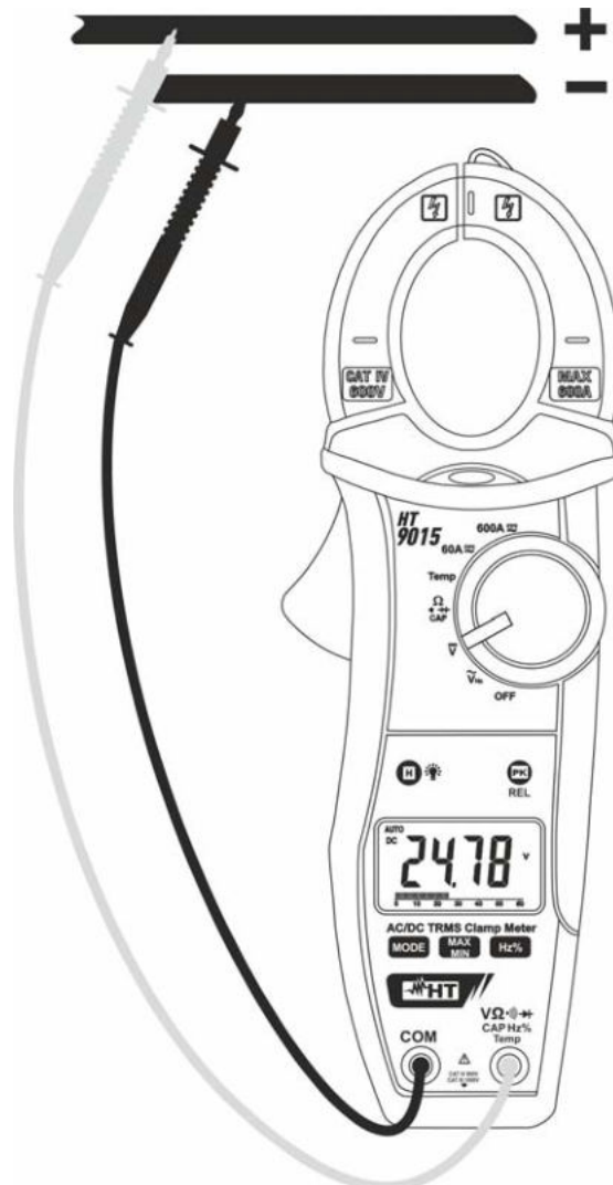
Fig. 4: Uso della pinza in misura di Tensione DC
