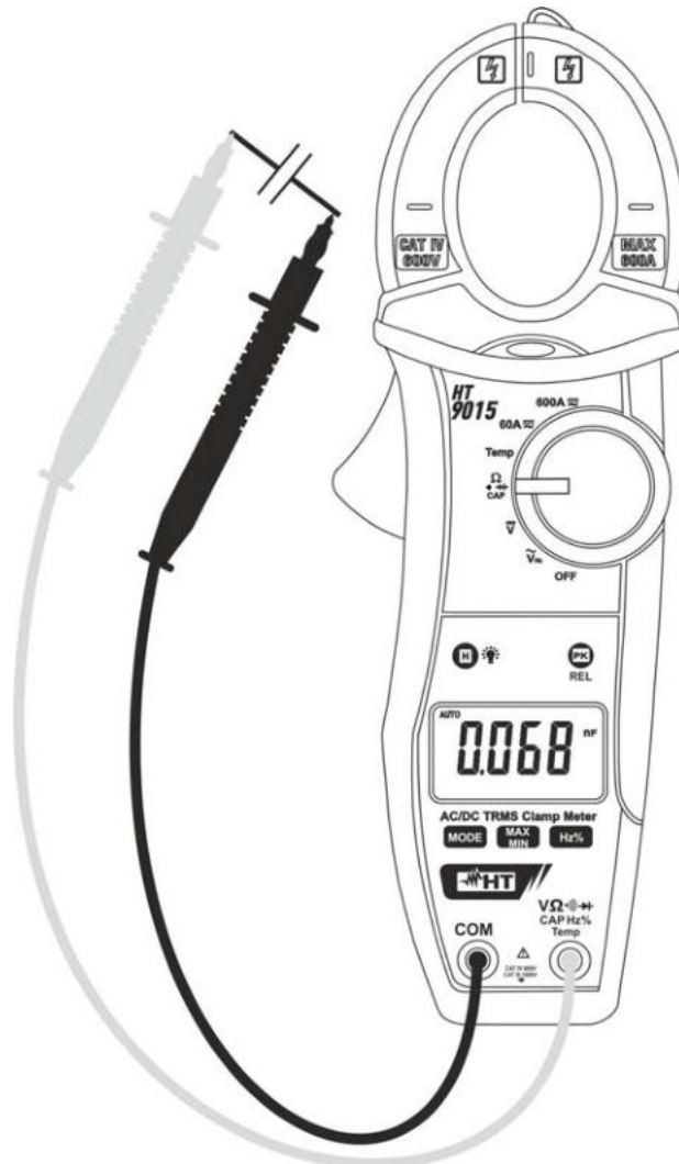
Fig. 7: Uso della pinza per misura di Capacità
