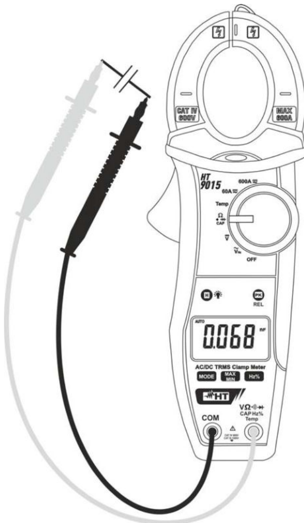
Fig. 7: Uso della pinza per misura di Capacità
