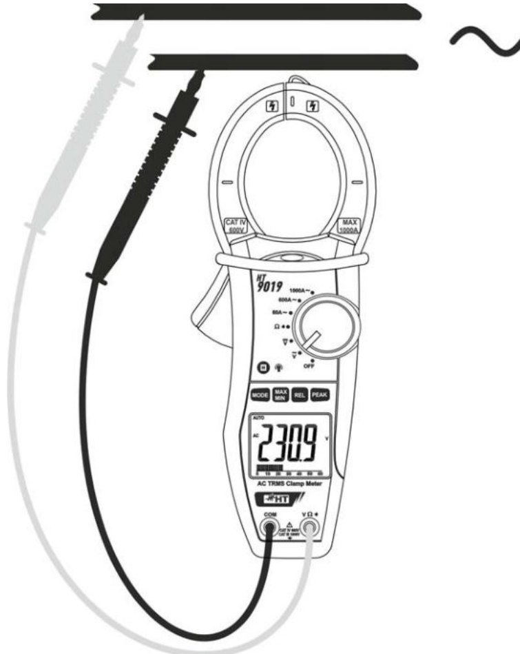
Fig. 3: Uso della pinza in misure di tensione AC
