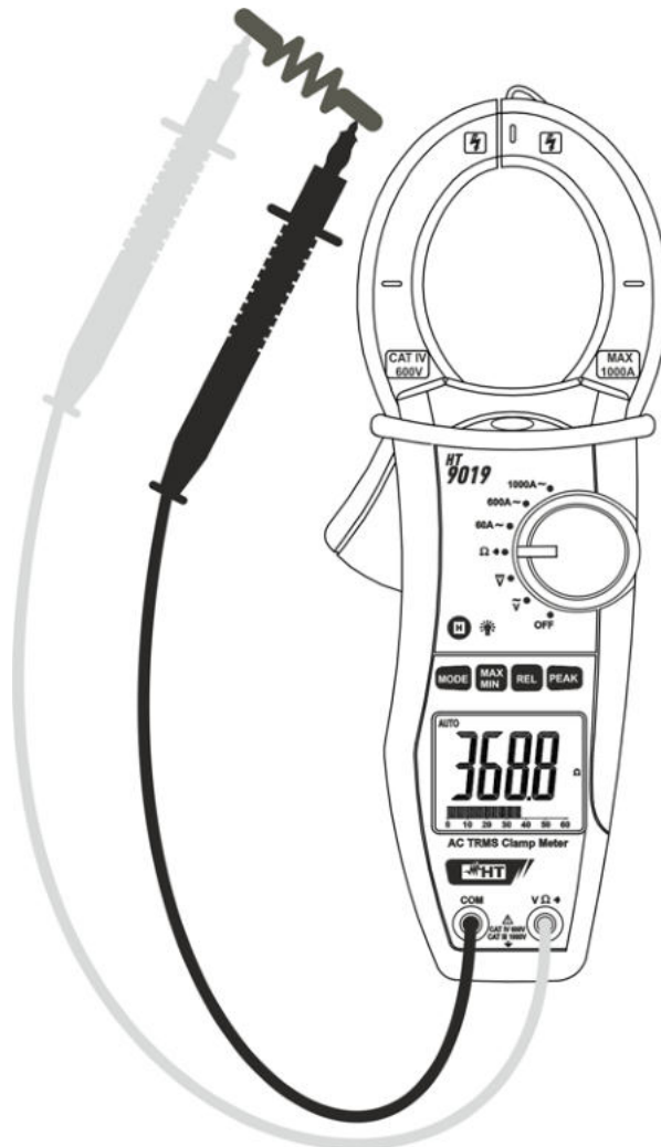
Fig. 5: Uso della pinza per misure di resistenza e test continuità
