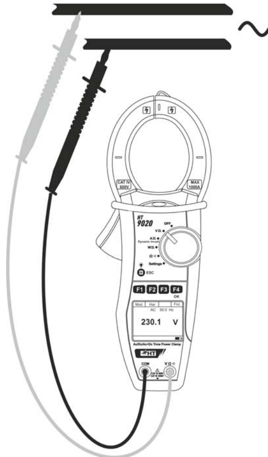
Fig. 6: Misura di Tensione AC+DC
