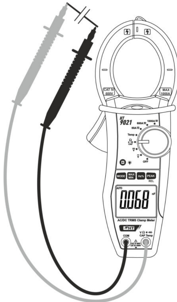
Fig. 7: Uso della pinza per misura di Capacità
