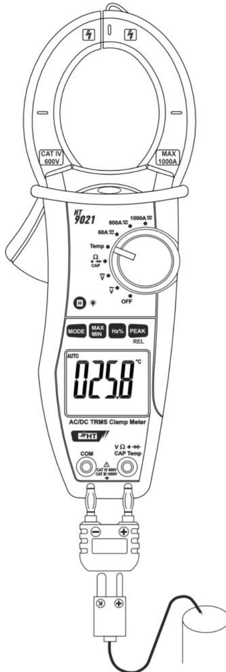
Fig. 8: Uso della pinza per misura di Temperatura
