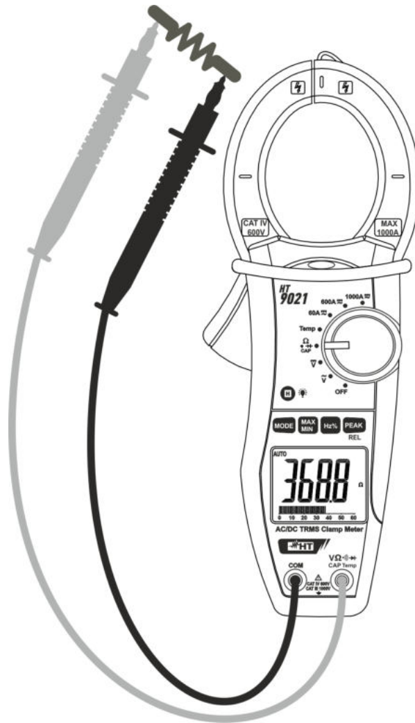
Fig. 5: Uso della pinza per misura di Resistenza
