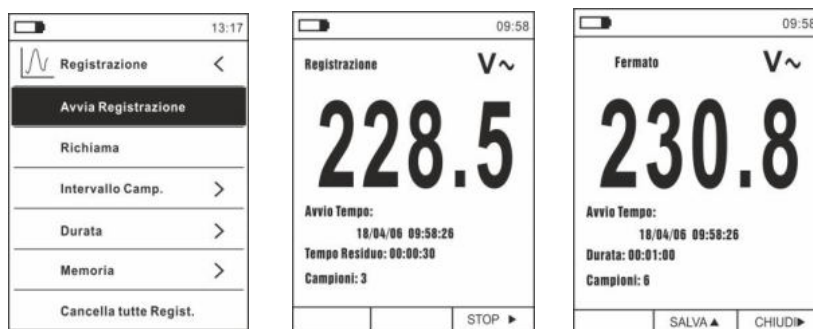
Fig.37: Data logger – Avvio e terminazione registrazione
