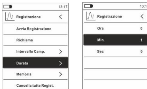
Fig.36: Data logger – Impostazione durata registrazione
