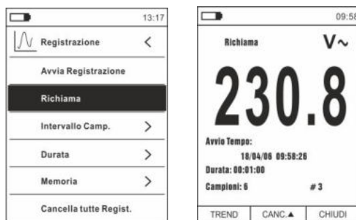
Fig. 38: Data logger – Richiamo a display dati registrazione
