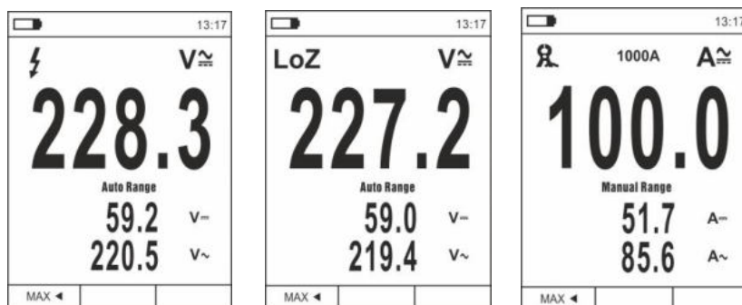
Fig. 6 Descrizione misura tensione e corrente AC+DC
