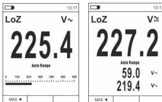
Fig. 10 Descrizione misura Tensione LoZ
