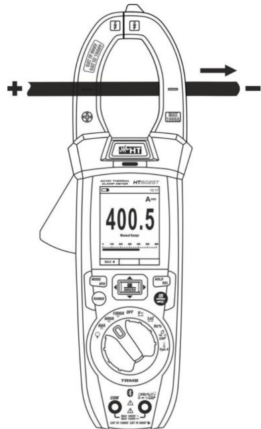
Fig. 31 Uso strumento per misura di Corrente DC Taking DC Current measurements
