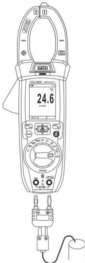
Fig. 30 Uso strumento per misura di Temperatura Taking Temperature measurements
