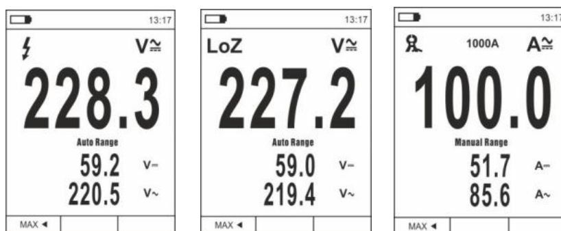
Fig. 6 Descrizione misura tensione e corrente AC+DC
