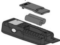
Fig. 14: Sostituzione batteria interna
