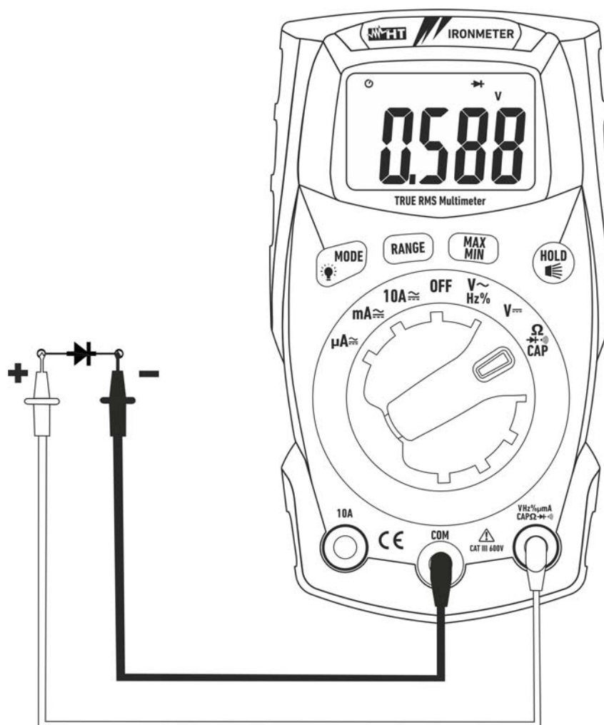
Fig. 6: Uso dello strumento per la Prova Diodi
