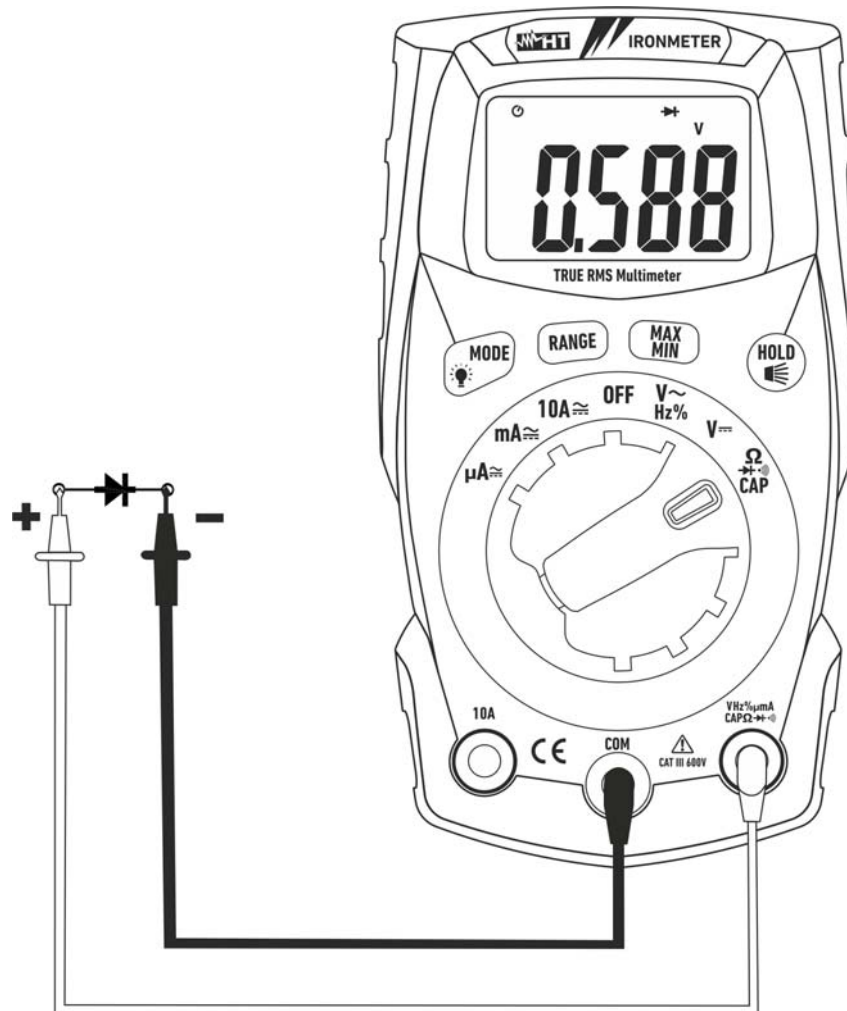
Abb. 6: Verwendung des Gerätes für Diodenprüfung
