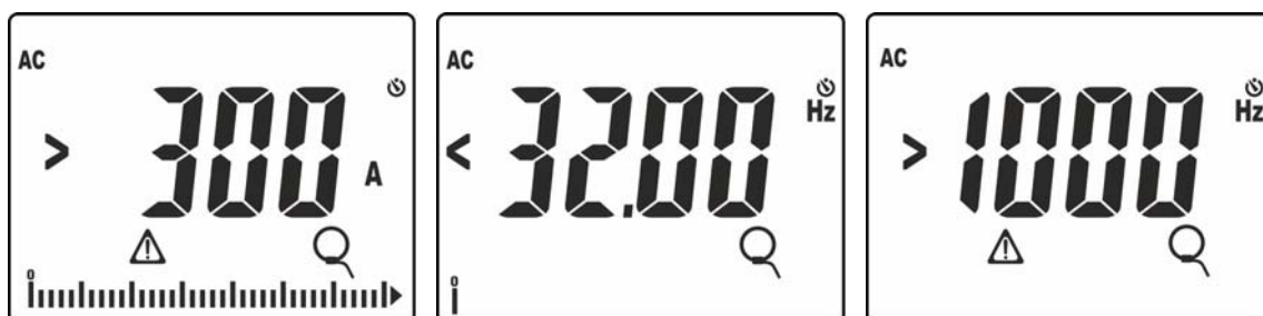
Fig. 41: Situazioni anomale sulla misura di corrente con trasduttori a pinza
