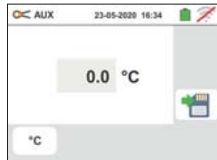
Fig. 33: Misura parametri ambientali con sonde esterne
