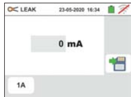
Fig. 27: Misurazione diretta della corrente di dispersione in impianti trifase
