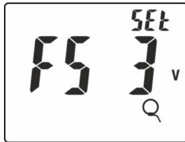
Fig. 5: Impostazione fondo scala pinza flessibile
