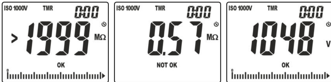
Fig. 21: Risultati della misura di isolamento in modo TMR
