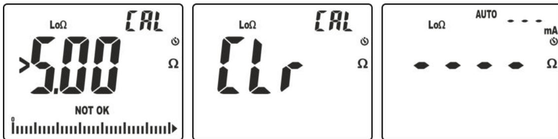
Fig. 34: Risultati azzeramento non eseguito correttamente
