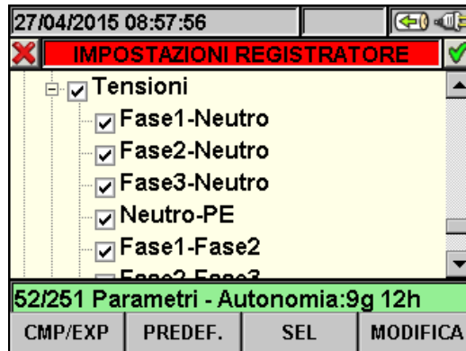
Fig. 60: Sottolivello Parametri Generali – Sistema trifase 4-fili
