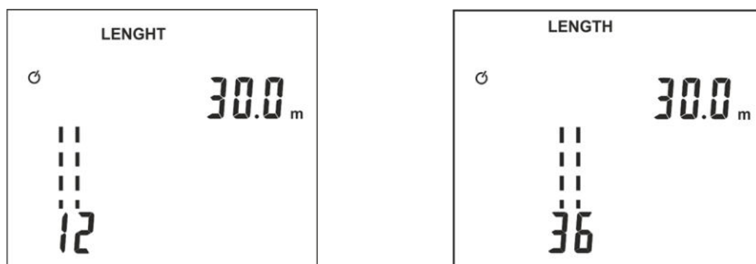
Fig. 14: Risultati della misura di lunghezza del cavo
