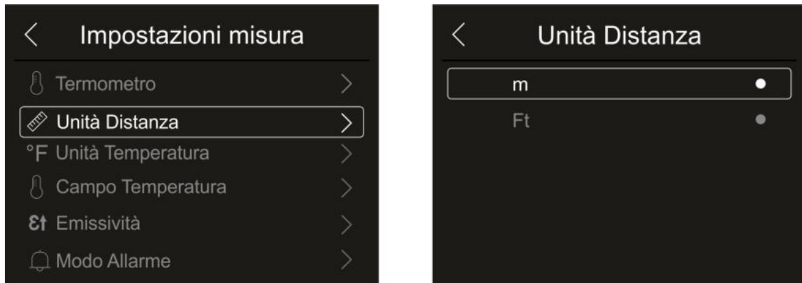
Fig. 24: Menu impostazione unità misura distanza
