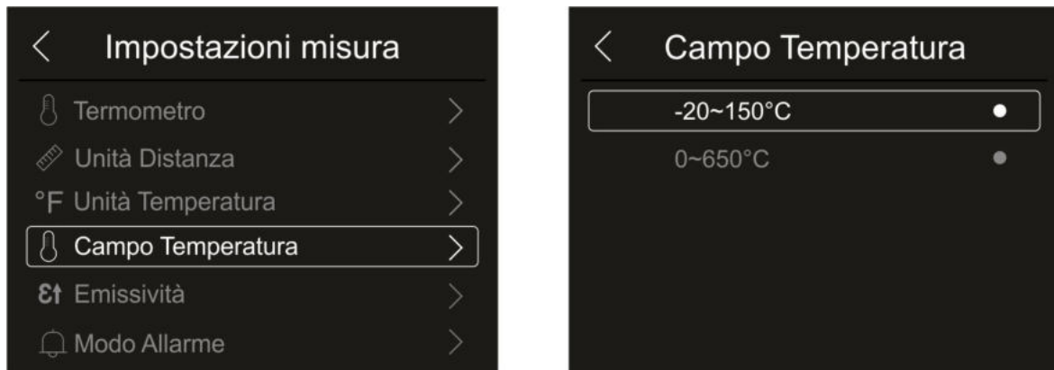
Fig. 26: Menu impostazione campo misura temperatura
