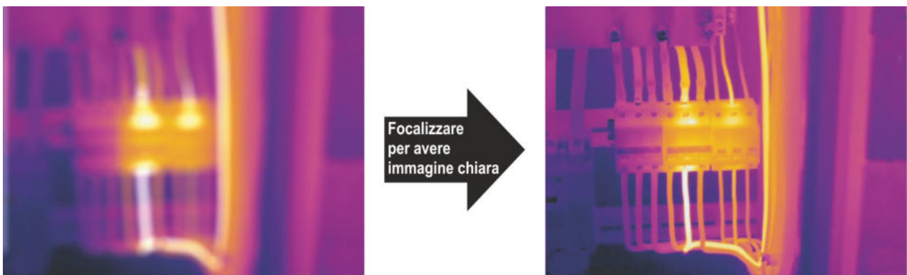
Fig. 7: Focalizzazione immagine a display
