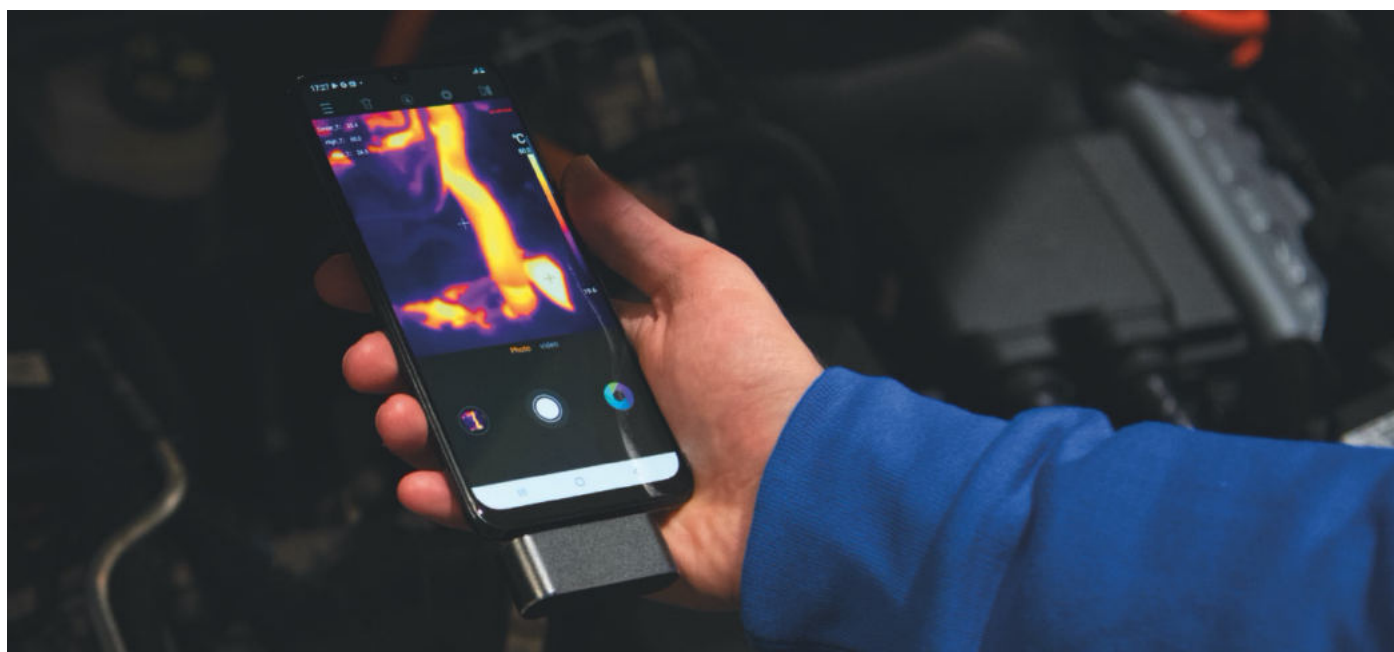
Collegamento termocamera THT8 a dispositivo mobile
