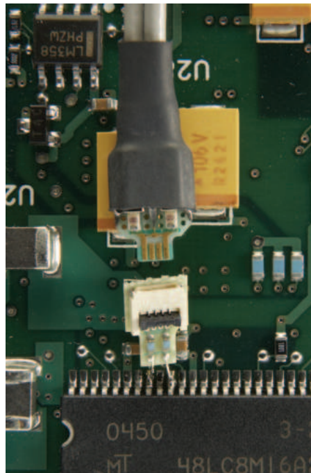
InfiniiMax ZIF tip soldered on board
