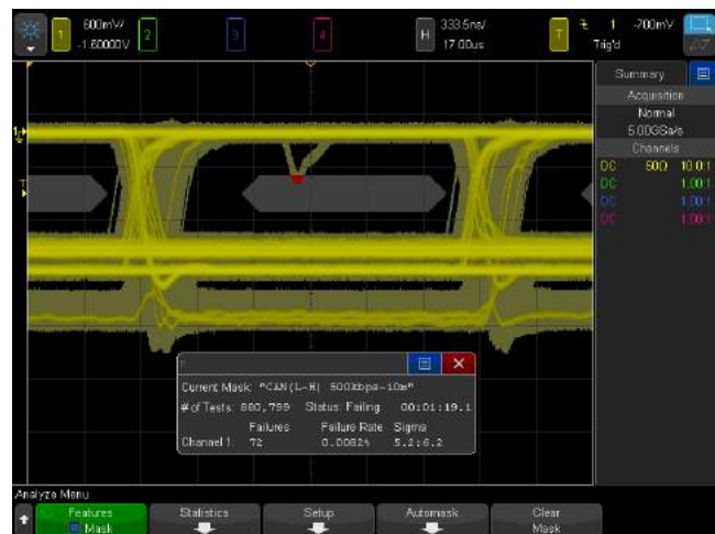
Figura 2: test di maschera (pass/fail) sul diagramma ad occhio del bus CAN differenziale utilizzando l'Automotive Best Bundle MSOX4154AUT.
