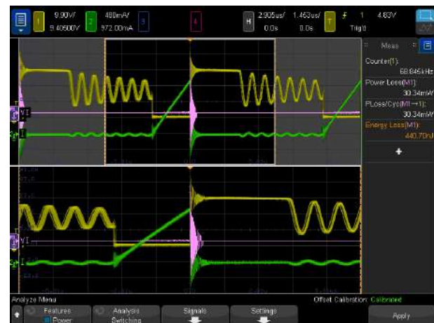
Figura 4: Misura dello switching loss utilizzando il power best bundle MSOX4154AUT.
