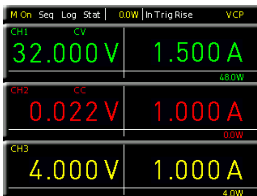
Abb. 4.5: Aktivierung von Kanal 1 und Kanal 2 mit MASTER ON
